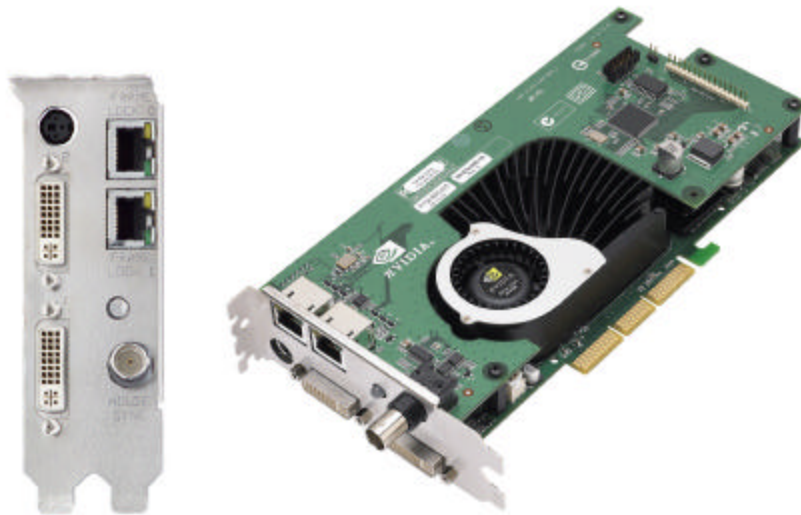
Figura 2. Quadro FX 3000G: una solución Quadro FX 3000 con función Genlock y sincronización de cambio de buffers
