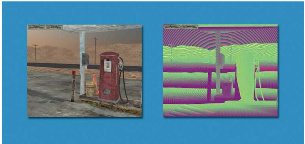
Figura 5. Buffer de colores (izquierda) y buffer de profundidad (derecha) de la escena sin iluminar.
